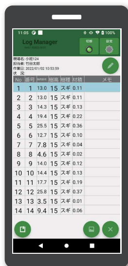
記録モード 電子輪尺で計測したデータを自動記録
